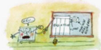
Dans la vanne thermostatique du radiateur, une **poche de gaz** se dilate ou se contracte selon la température ambiante, laissant donc plus ou moins circuler la chaleur dans le radiateur, et ce jusqu'à donner au radiateur, donc au local, la température souhaitée!
