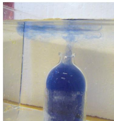
L'eau chaude colorée sort de la bouteille et est remplacée par de l'eau froide
