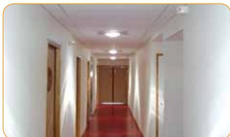
Repeindre en clair les couloirs, les locaux aux murs sombres... permet souvent d'abaisser la puissance des lampes (= dévisser une lampe sur 2 ou sur 3 ?). Par exemple, un mur de brique rouge présente un coefficient de 0,15. Donc 85% de la lumière qui le frappe est absorbé ! Contre 20% pour un mur blanc...
