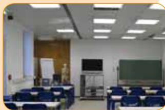
Dans les luminaires près des fenêtres, dévisser une lampe sur deux est généralement possible, avec un éclairage qui reste correct sur les bancs (minimum de 300 lux), car la lumière naturelle est suffisante. Ces luminaires ont été dimensionnés pour éclairer le local durant la nuit... Un seul tube dévissé, c'est de 10 à 15 € d'électricité économisée/an, environ. Et une école dispose souvent de luminaires près de grandes fenêtres.
